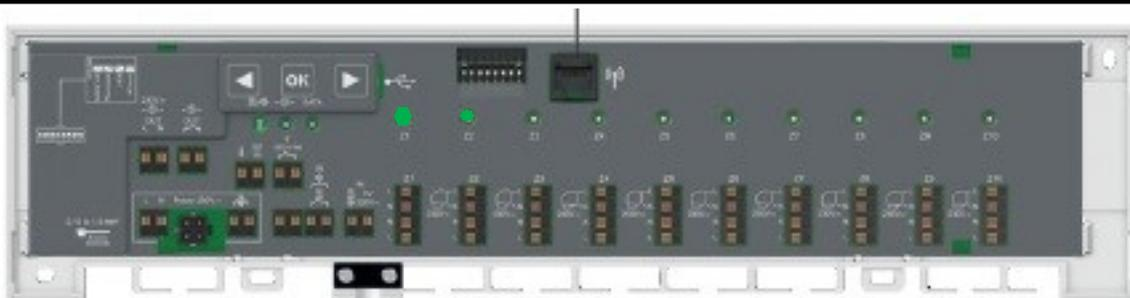
6. Når alle kanalene er ferdig parett med en termostat, går man ut av paringsmodus ved å holde nede **pil venstre** til kanal Z1[**THER.**] blinker **RØDT**. Så er det bare å vente til masteren går ut av paringsmodus etter ca. 1 minutt.
