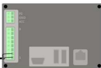
ES Värmepumpens manöverpanel
