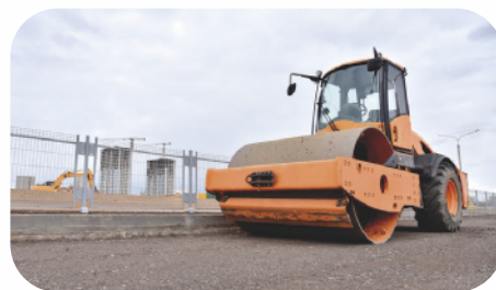
● ROLO COMPACTADOR, TAMBÉM CONHECIDO COMO ROLO COMPRESSOR DE ASFALTO.
