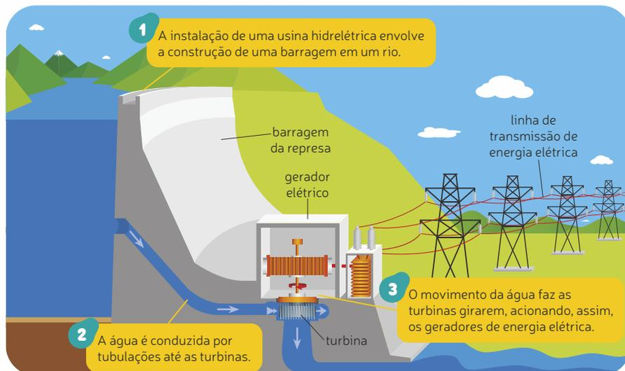
● Representação da estrutura interna e do funcionamento de uma usina hidrelétrica.
