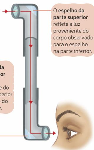
O espelho da parte superior reflete a luz proveniente do corpo observado para o espelho na parte inferior.
