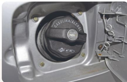
▲ Detalhe da entrada do tanque de combustível de automóvel flex, isto é, movido tanto a etanol quanto a gasolina.
