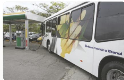
▲ O ônibus movido a etanol é menos poluente que os veículos a diesel.
