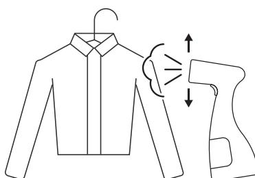
**REMARQUE :** le défroisseur à vêtements est conçu pour être utilisé en position verticale sur des vêtements suspendus. Pour des retouches occasionnelles, le défroisseur peut être utilisé en position horizontale.
