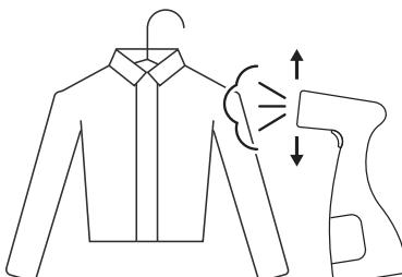
**OPMERKING:** De Garment Steamer is ontworpen om rechtop te worden gebruikt bij hangende kleding. Voor occasionele bijstellingen kan de steamer in een horizontale positie worden gebruikt.
