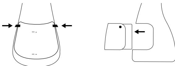
Abra la tapa de la entrada de agua y vierta agua del grifo en el tanque de agua hasta que alcance el MÁXIMO. Reemplace el tanque de agua ⑥.
