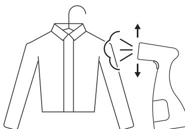
**NOTA:** El vaporizador de prendas está diseñado para usarse verticalmente en prendas colgadas. Para retoques ocasionales, el vaporizador puede usarse en posición horizontal.
