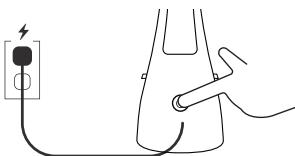
Cuando esté lleno de agua, conecte el cable de alimentación ⑨ y presione el botón de encendido ⑦ en la parte posterior de la unidad.
