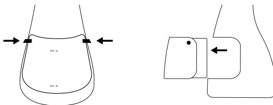
Ouvrez le bouchon du réservoir d'eau ⑥ et remplir avec de l'eau du robinet jusqu'à ce qu'elle atteigne la ligne MAX. Replacez le réservoir d'eau ⑥.
