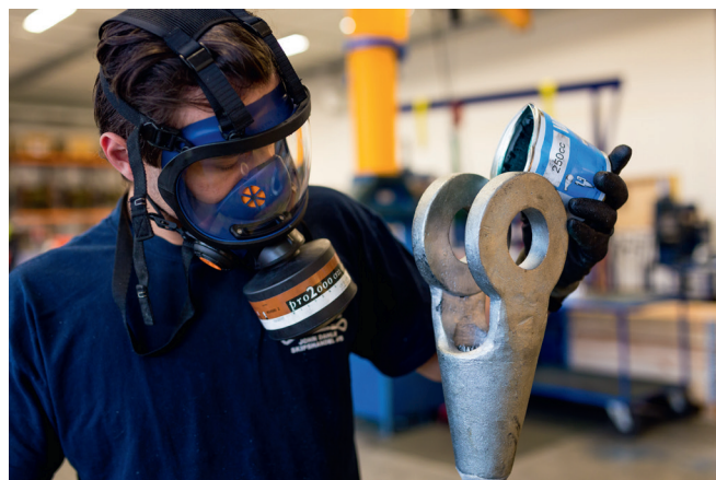
Støping av socket. FOTO: ESPEN MILLS
