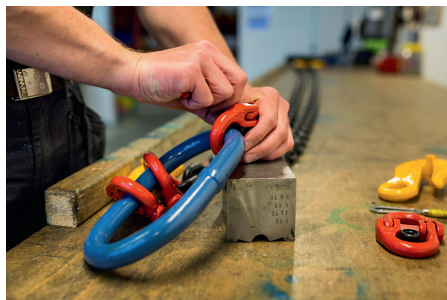
Produksjon av kjettingsling på vårt eget verksted. FOTO: ESPEN MILLS
