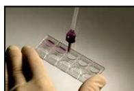
À l'aide de la **pipette KOVA Plastics**, transférez l'échantillon dans l'encoche découpée sur le compartiment de la lame. Placez la pipette parallèlement à la lame lorsque vous remplissez le compartiment. Évitez de toucher la barrière en forme de V lors de la distribution du fluide. Un positionnement incorrect lors de la distribution peut entraîner un débordement d'un compartiment à l'autre. L'ajout minutieux d'échantillons assure les propriétés de manipulation hygiénique du **système KOVA**.
