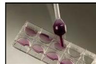
Par action capillaire, **6,6 µL** de l'échantillon seront aspirés dans le compartiment de la **lame KOVA Plastics 10**, ce qui donnera une suspension homogène du sédiment. Ne pas réutiliser les produits KOVA.
