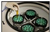
Transférez **12 mL** de l'échantillon d'urine du **gobelet stérile KOVA Plastics** dans le **tube KOVA Plastics**. Fixez le **gobelet stérile KOVA Plastics** sur le **tube KOVA Plastics**, puis centrifugez à une **FCR de 400** (-1 500 tr/min) pendant **5 minutes**.
