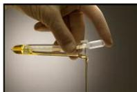
Insérez fermement la **pipette KOVA Plastics** au fond du tube et assurez-vous que le clip sur le réservoir est accroché sur le bord extérieur du **tube KOVA Plastics** et puis procédez au décantage. **1,0 mL** de sédiments sera retenu par la **pipette KOVA Plastics**.
