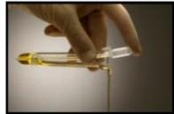
Masukkan **Pipet KOVA Plastics** dengan kemas ke bahagian bawah tiub dan pastikan klip pada bebuli terlekat pada tepi luar **Tiub KOVA Plastics** dan tuangkan. **1.0mL** sedimen akan terperangkap oleh **Pipet KOVA Plastics**.
