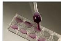
Mediante azione capillare, **6,6 µl** del campione saranno prelevati nello scomparto del vetrino KOVA Plastics 10 con conseguente sospensione omogenea del sedimento. Non riutilizzare i prodotti KOVA.
