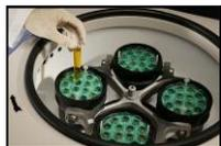
Trasferire **12 ml** del campione di urina dal contenitore KOVA Plastics alla provetta KOVA Plastics. Fissare il tappo KOVA Plastics alla provetta KOVA Plastics e centrifugare a **400 ref** (-1.500 giri/min) per **5 minuti**.
