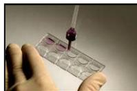
Utilizzando la pipetta con bulbo KOVA Plastics, trasferire il campione nell'incavo sagomato dello scomparto del vetrino. Posizionare la pipetta parallelamente al vetrino durante il riempimento dello scomparto. Durante l'erogazione del liquido, evitare di toccare la barriera a forma di V. Il posizionamento scorretto durante l'erogazione può causare lo straripamento da uno scomparto all'altro. L'aggiunta delicata di campioni garantisce le proprietà igieniche di manipolazione di KOVA System.
