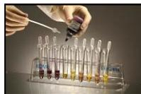
Risospendere delicatamente con la pipetta con bulbo KOVA Plastics. Aggiungere **1 goccia di colorante KOVA** prima della risospensione, se necessario, per una migliore quantificazione.
