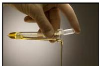
Inserire saldamente la pipetta con bulbo KOVA Plastics sul fondo della provetta e assicurarsi che la clip sul bulbo sia agganciata al bordo esterno della provetta KOVA Plastics e fare decantare. **1,0 ml** di sedimento sarà intrappolato dalla pipetta con bulbo KOVA Plastics.
