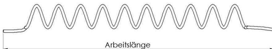
\*Die Arbeitslänge ist die maximal zulässige Streckung (Grenzwert). Nach überschreiten des Grenzwertes kann eine bleibende Verformung eintreten.
