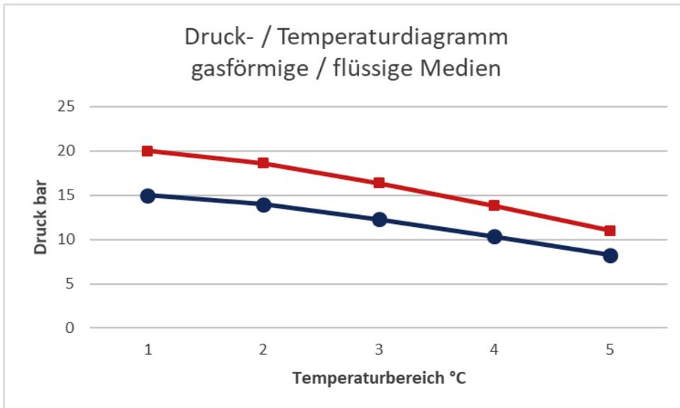
Hinweis: Gilt nur für Schläuche mit einem max. Betriebsdruck (Luft / Flüssigkeiten) von 15 / 20 bar
