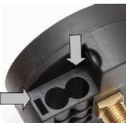
Das Batteriefach öffnen, die alten Batterien entfernen und durch neue ersetzen. (Auf korrekte Polarität achten!) Im Anschluss das Batteriefach wieder schließen, den Gummischutz wieder überstülpen und den Füllschlauch anbringen.
