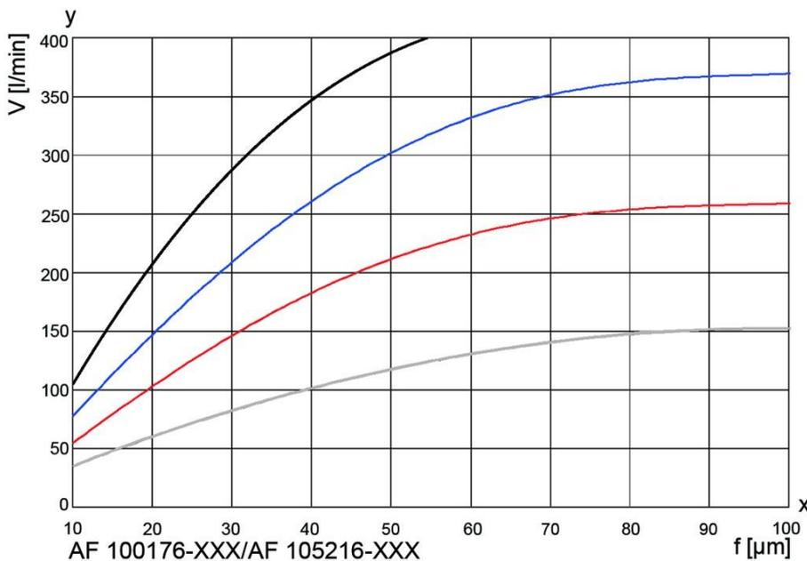
Die Kurven geben den Volumenstrom durch das komplette Filtersystem (Filtergehäuse inkl. Filterelement) an und beziehen sich auf einen Differenzdruck von 0,3 bar. Für den betriebssicheren Einsatz von Automatikfiltern sind spezifische Informationen über die Prozessdaten erforderlich.
