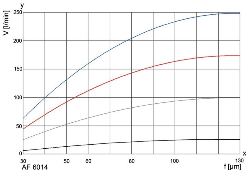
Le curve indicano il volume che passa attraverso il completo Sistema di Filtrazione (corpo filtro inclusa la cartuccia) e sono riferite ad una pressione differenziale di 0,3 bar. Informazioni specifiche del processo sono essenziali per garantire un funzionamento affidabile del filtro automatico.
