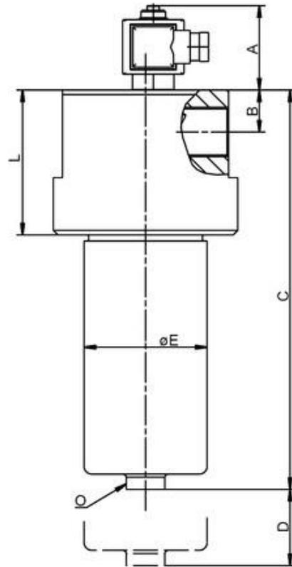
Durch Umstecken des elektrischen Schaltteiles um 180° kann die Schaltfunktion geändert werden (Öffner oder Schließer). Lieferzustand ist Öffner. Bei Induktivität im Gleichstromkreis ist der Einsatz von Löschgliedern zu überprüfen. Weitere Angaben und weitere Ausführungen von Wartungsanzeigern enthält das Datenblatt Wartungsanzeiger.
