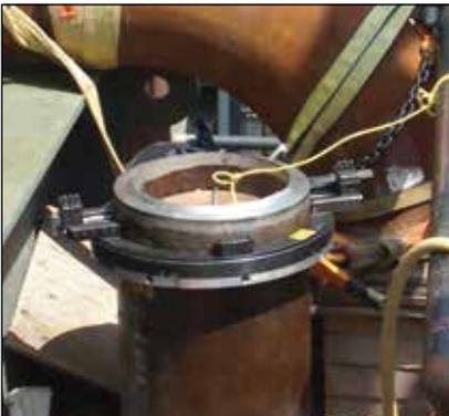
◀ Coupe-tube ouvrable NB (Narrow Body)
