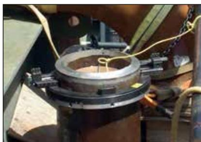
◀ Cortadora orbital de corpo delgado modelo NB.
