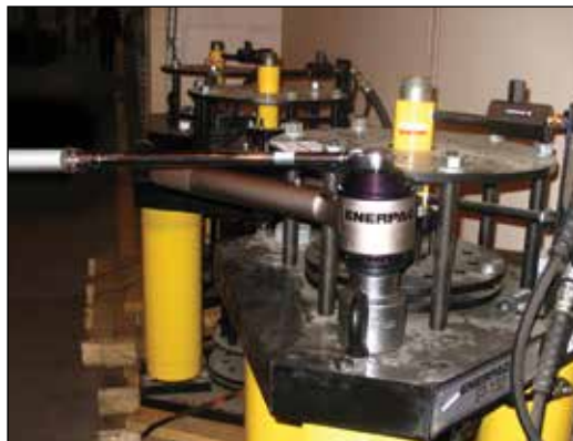
◀ Multiplicador de par con barra de reacción E393 de Enerpac utilizado para apretar manualmente pernos con hasta 3200 pies-libras (4340 Nm).
