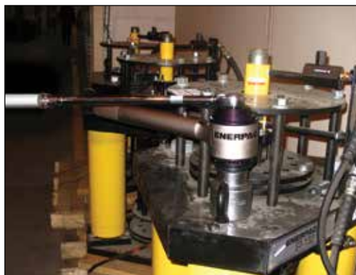
◀ Braço de Reação Enerpac para o Multiplicador de Torque E393 usado para multiplicar manualmente o torque nos parafusos até 4300 Nm.
