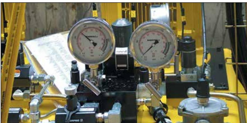
◀ Al levantar o presionar, siempre utilice un manómetro. Un manómetro es su "ventana" al sistema y le permite saber lo que está pasando.
