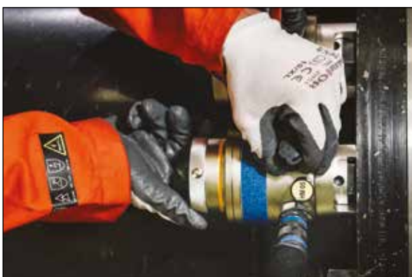
◀ Die HydraMax®-Vorspannzylinder der HM-Serie von Enerpac erzeugen hohe Vorspannkräfte in Verbindung mit Kompaktflanschen und sind dank der maximalen Bolzenabdeckung vielseitig einsetzbar.
