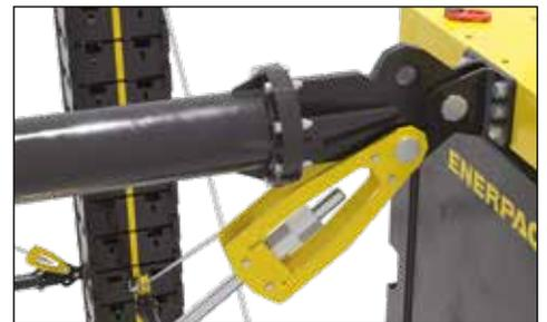
Dettagli: ancoraggio e barra Dywidag, terminale di sostegno, occhiello per blocco di rinforzo. ▶
