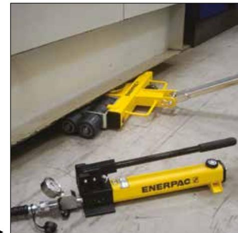
Um conjunto de roletes de máquina Série MLS da Enerpac combinado com um cilindro hidráulico de baixa altura fornece o pacote ideal para movimentos de máquinas pesadas. ▶
