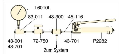
▲ Typisches Testsystem mit Dämpfungsventil 72-750
