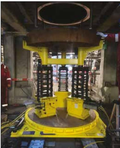
◀ *Intervento di manutenzione dello scambiatore di calore sulle tubazioni e sui condensatori di una raffineria che utilizza una combinazione delle tecnologie di sollevamento pesante Enerpac: martinetti cubici della serie SCJ, piattaforma girevole oleodinamica della serie ETT e sistemi di scorrimento ad altezza ridotta della serie LH.*
