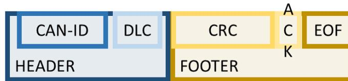
Die Länge der gesamten Nachricht ist von zwei Faktoren abhängig: zuerst einmal stark von der Anzahl der Nutzdaten und zum Zweiten von der Länge der CAN-ID; s. Kapitel 4.3.2 *Bedeutung der CAN-ID*.
