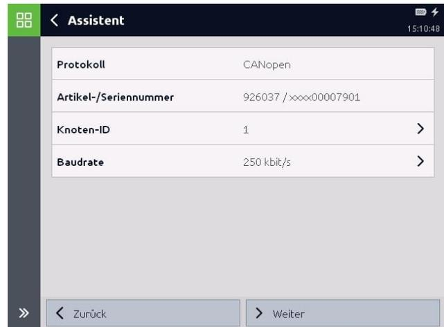
Wie im Kapitel 4.7.1 *LSS Kommunikationsmodell* beschrieben sollte immer nur ein Gerät mit dem HMG 4000 verbunden sein, wenn diese Funktion genutzt wird. Mit der Schaltfläche „Weiter“ wird die Suche nach ein LSS fähigen Gerät gestartet und dessen *LSS-Adresse* ausgelesen. Anschließend kann die *Baudrate* und *Node-ID* geändert werden.
