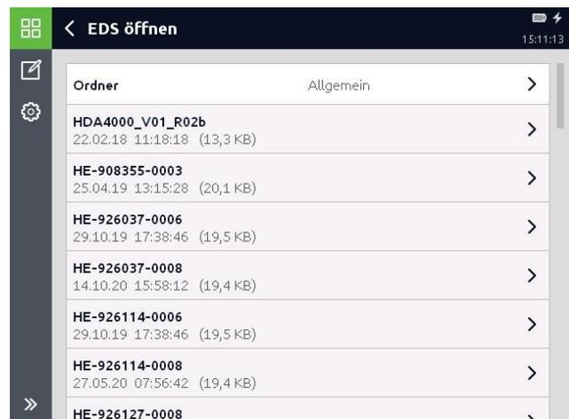
Bei Anwendung dieser Funktion können mehrere Geräte gleichzeitig angeschlossen sein, daher ist es unerlässlich, dass die *Node-ID* (Knoten-ID) des gewünschten Gerätes vor dem Einlesen ausgewählt wird.
