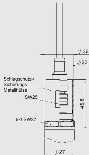
Die Schlagschutz- / Sicherungs-Metallhülse ist im Lieferumfang enthalten. Für den elektr. Anschluss ist eine gerade Kupplungsdose erforderlich. Z.B. Kupplungsdose M12x1, 4-polig, gerade mit 3m Leitung geschirmt: ZBE 06S-03, Mat.-Nr. 6098243
