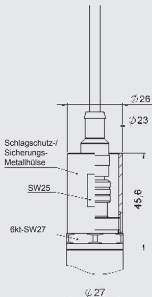
Die Schlagschutz- / Sicherungs-Metallhülse ist im Lieferumfang enthalten. Für den elektr. Anschluss ist eine gerade Kupplungsdose erforderlich. Z.B. Kupplungsdose M12x1, 4-polig, gerade mit 3m Leitung geschirmt: ZBE 06S-03, Mat.-Nr. 6098243
