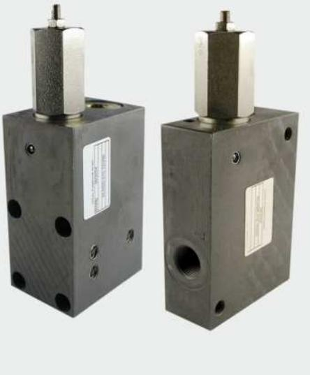
Das Speicherladeventil DLHS D / R ist ein vorgesteuertes, federbelastetes Schieberventil im Plattenaufbau- oder Rohrleitungsgehäuse. Es hat die Aufgabe, innerhalb eines vorgegebenen Schaltbereichs, die Ladung des Hydrospeichers zu regeln. In die Schaltung sind eine Vorsteuerstufe mit definierter Hysterese, ein Hauptkolben und ein Rückschlagventil eingebaut.
