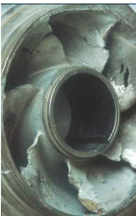
Figure 173: Phénomène de cavitation sur des aubes de pompe centrifuge
