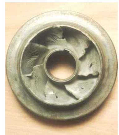
Figure 173: Phénomène de cavitation sur des aubes de pompe centrifuge
