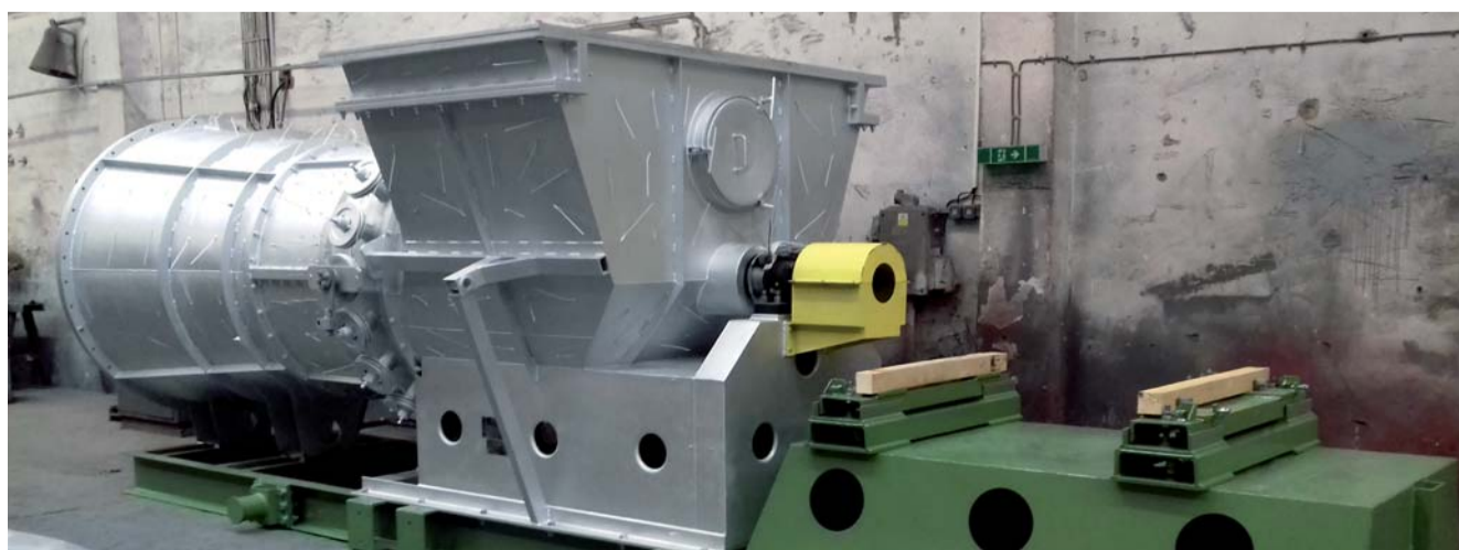
Ocelárna Hoa Phat bude vybavena ventilátory ARM pro provoz v linkách na jímání konvertorového plynu.
