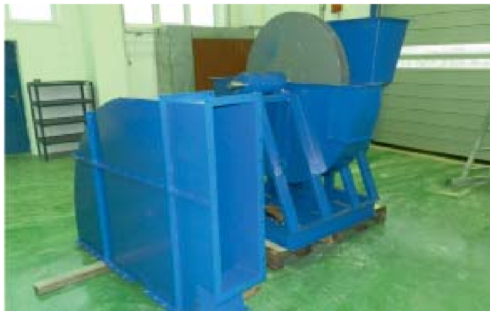
Prototyp ventilátoru RVN s demontovanou vrchní částí spirální skříňe.
