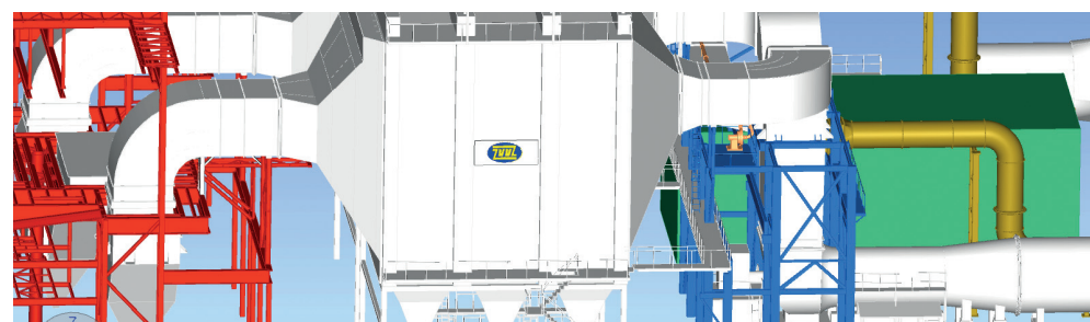
Elektro odlučovače po rekonstrukci na látkových filtrech.
