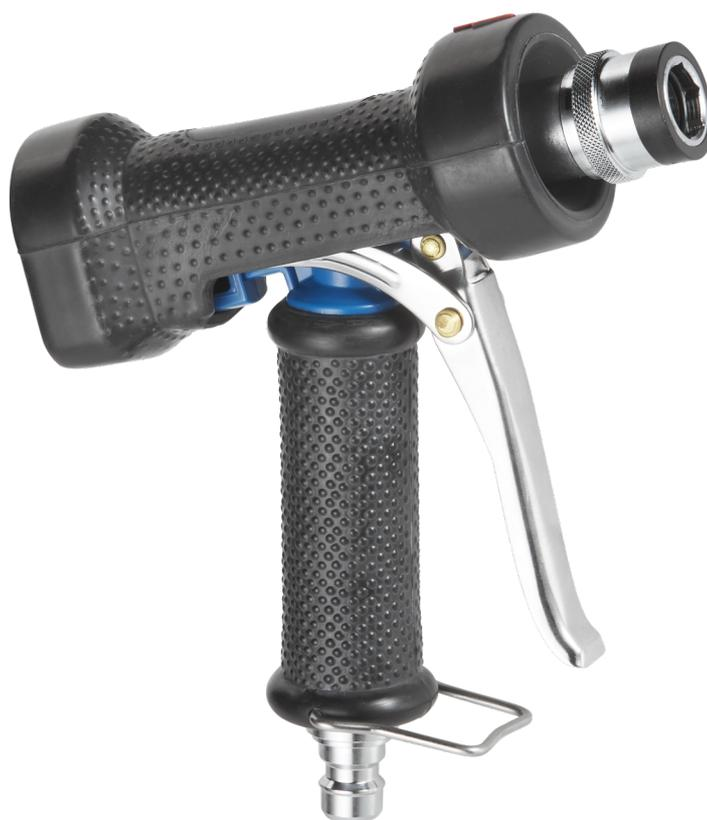
Il s'agit d'une pièce de rechange pour le Kit de nettoyage mousse (9303x). Un revêtement en caoutchouc assure une excellente prise en main pendant l'utilisation, même en conditions humides. Ce pistolet à mousse dispose d'un raccord 1/2" qui peut être connecté à un raccord 1/2" Q. Le nez du pistolet peut être raccordé aux buses de rinçage 9350, 9352 et 9354.
