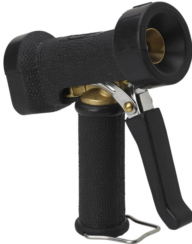
Cette lance à eau convient au nettoyage des sols et des machines, et au rinçage des surfaces de travail et des murs après un nettoyage à la mousse. Réglez la forme du jet en faisant varier la pression sur la gâchette avec revêtement isolant en caoutchouc. Réglez la puissance du jet à l'aide d'une vis à l'extrémité de la lance. Le sens du jet est indiqué par une flèche. Vissez un embout 1/2" (réf. 0712) ou 3/4" (réf. 0715) à la base de la lance pour raccorder un tuyau.
