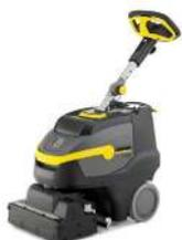
Dotée d'une tête de brossage articulée, d'un volant de direction et de dimensions compactes, BR 35/12 C Bp Pack excelle dans le nettoyage des petites surfaces et des zones encombrées. Elle nettoie aussi bien en marche avant qu'en marche arrière. Sa puissance de brossage et son aspiration de qualité font d'elle un outil efficace sur tout type de sol.
