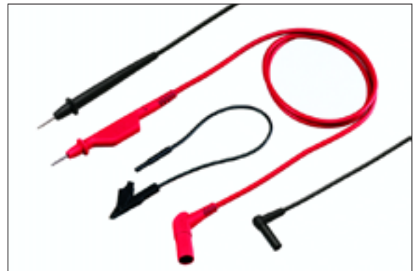
Figura 2: Los cables de prueba STL120 (rojo) y TL75 (negro) son los instrumentos principales para realizar conexiones de prueba en FOUNDATION Fieldbus. Si se encuentra un nivel elevado de ruido en el bus, utilice el cable más corto con la pinza de cocodrilo (accesorio central). Estos tres accesorios son estándar para el Scopemeter Fluke 125.
