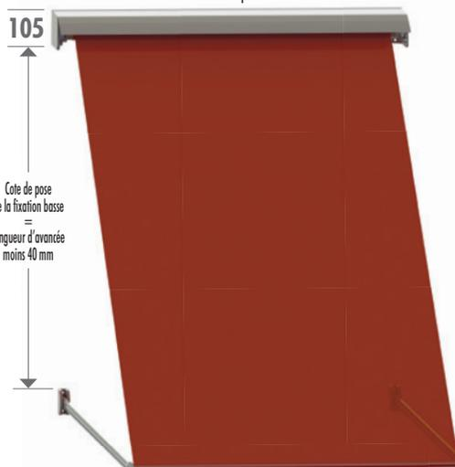
Cote de pose de la fixation basse = longueur d'avancée moins 40 mm
