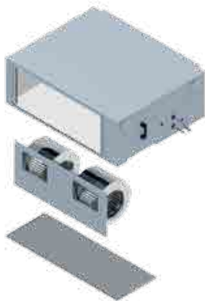
Bottom fan deck removal
