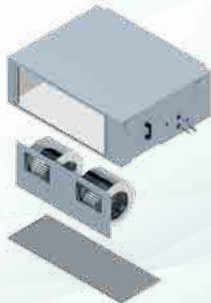
Bottom fan deck removal
