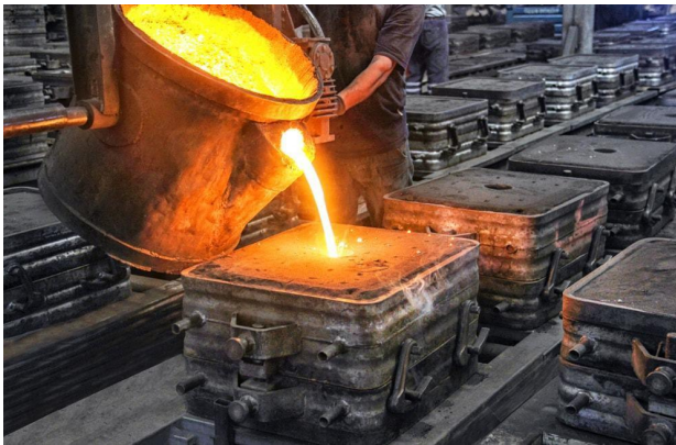
(b) Moulds ready for pouring
