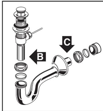
**8** Fixer le lavabo au support selon les indications présentées à l'étape 5. Insérer et serrer les vis d'ancrage (le cas échéant). Raccorder les conduits d'alimentation d'eau chaude et d'eau froide aux soupapes de fermeture d'eau. Resserrer les joints du siphon pour rendre l'ensemble étanche. Appliquer un trait de mastic de plomberie le long de la surface en contact avec le mur (selon ce qui est indiqué).
