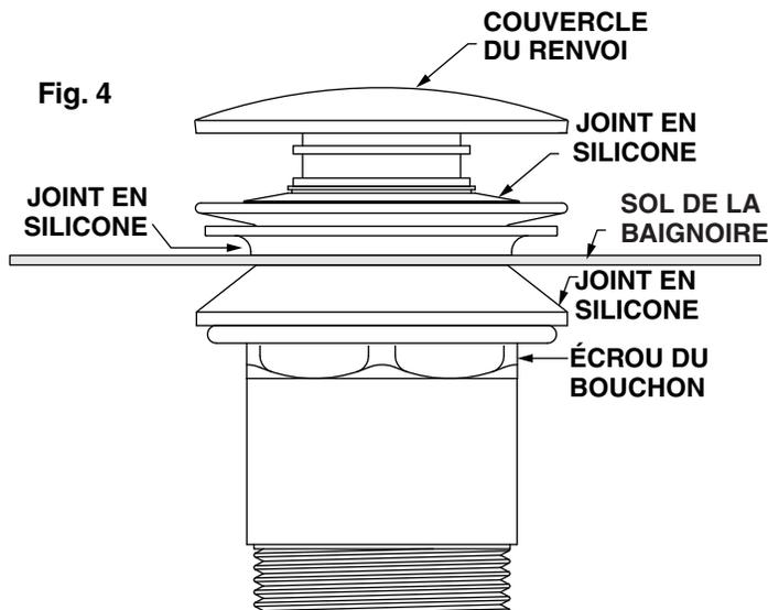
**4** Serrez l'écrou de renvoi à l'aide de la clé à tuyau et la clé à bonde. Assurez-vous que tous les joints en silicone sont dans la bonne position (comme illustré dans la figure 4) et qu'il n'y a pas de fuite.
