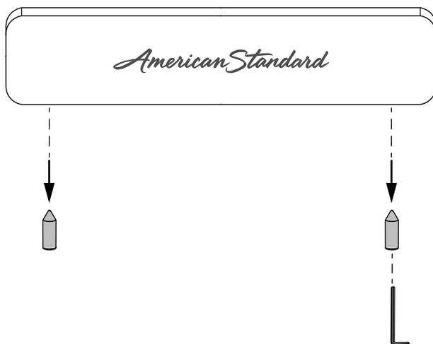
**2** Remplacez le couvercle avec le couvercle de trop-plein fourni dans cet ensemble. Utilisez la clé hexagonale pour serrer les 2 vis de pression. (Voir la figure 2)
