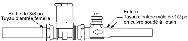
La butée et le solénoïde devront être montés dans un emplacement accessible séparé. Ne peuvent être installés dans un boîtier de robinetterie brute de 4 po (10,16 cm).
