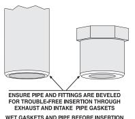
WET GASKETS AND PIPE BEFORE INSERTIO
