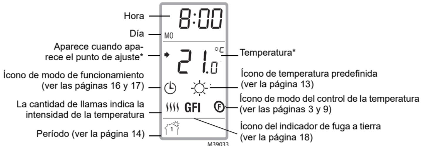
\* El termostato indica normalmente la temperatura real (medida). Para ver la temperatura del punto de ajuste, presionar brevemente uno de los botones ▲▼. El punto de ajuste aparecerá durante 5 segundos. Para cambiar la temperatura del punto de ajuste, presionar uno de los botones ▲▼ hasta que se visualice la temperatura deseada. Para hacer desfilar más rápido la temperatura del punto de ajuste, mantener el botón presionado.
