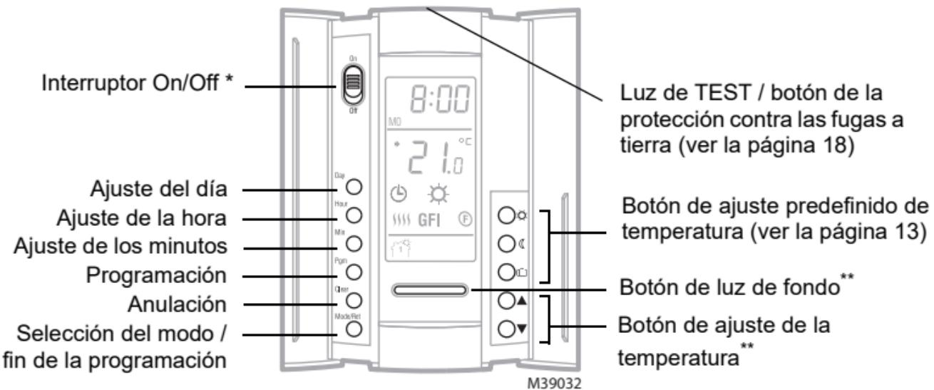
\* Poner el interruptor en **Off** para apagar el aparato. Esto no afectará los ajustes de hora y temperatura.
