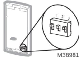
1. La fonction de Démarrage anticipé n'est utilisée qu'en mode Automatique. Lorsque la fonction est activée, le thermostat détermine l'heure d'activation du chauffage afin que la température Confort soit atteinte au début des périodes 1 et 3. Lorsque la fonction est désactivée, le chauffage ne démarre qu'au début des périodes 1 & 3; donc il y a un délai avant que la température Confort soit atteinte.
