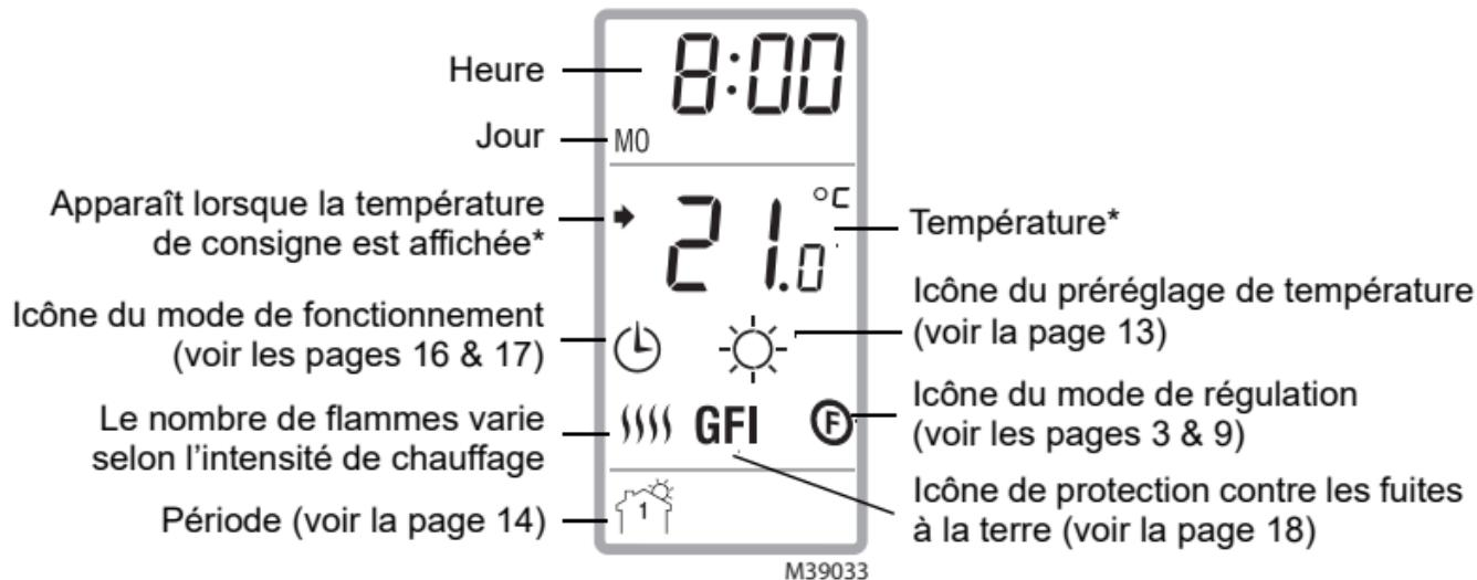
\* Le thermostat affiche normalement la température réelle (mesurée). Pour voir la température de consigne, appuyer brièvement sur l'un des boutons **▲▼**. La consigne sera affichée pendant 5 secondes. Pour changer la température de consigne, appuyer sur l'un des boutons **▲▼** jusqu'à ce que la température désirée soit affichée. Pour faire défiler la température de consigne plus rapidement, maintenir le bouton enfoncé.
