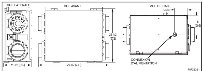
Fig. 1. Dimensions en po (mm) et dégagements.
