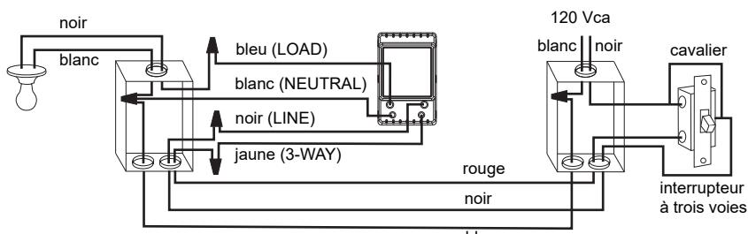
Relier le fil « LOAD » du TI072 au fil « commun » identifié lorsque vous avez enlevé l'ancien interrupteur. Relier les fils « NEUTRAL » aux fils neutres (blancs). Relier les fils « LINE » et « 3-WAY » aux deux fils restants. Pour l'autre interrupteur à 3 voies, relier le fil de raccord (fourni) entre la borne « commun » et la borne sur laquelle le fil « LINE » du TI072 est relié.
